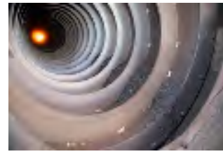
特殊な連続釜で焼成。この時、釜内ガス温度は1350度にも及びます。
